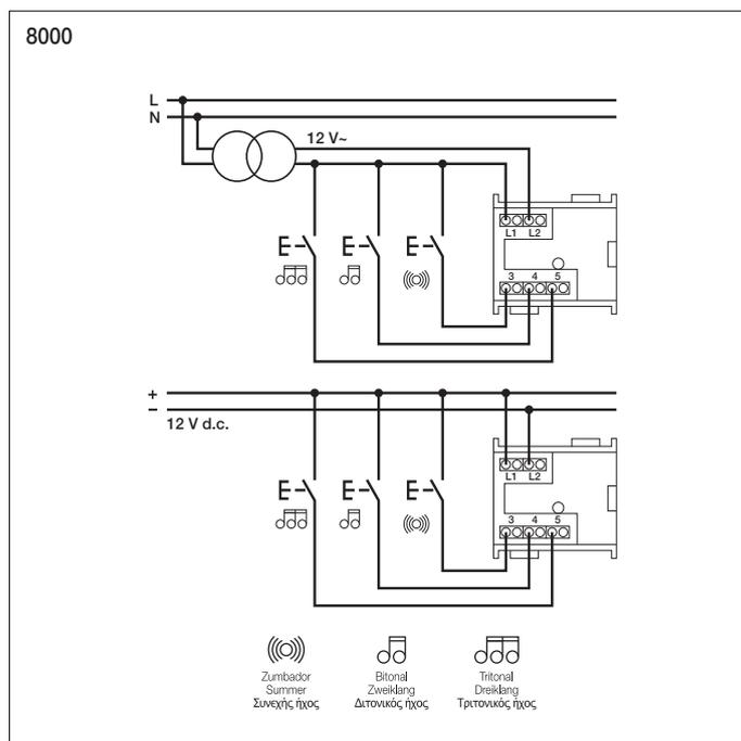
Si se desea utilizar el timbre electrónico en lugar de un timbre de dos hilos, hay que efectuar las conexiones descritas en los esquemas siguientes.
