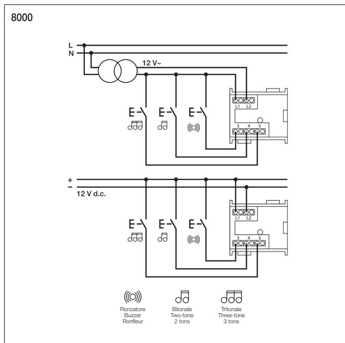
Nel caso si volesse utilizzare la suoneria elettronica in sostituzione di un campanello a due fili, è possibile realizzare i collegamenti indicati negli schemi riportati di seguito.
