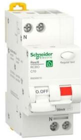
Interruttori magnetotermici differenziali (RCBO), Resi9, 1P+N, 10 A, curva C, 4500 A, 30 mA, Tipo AC
